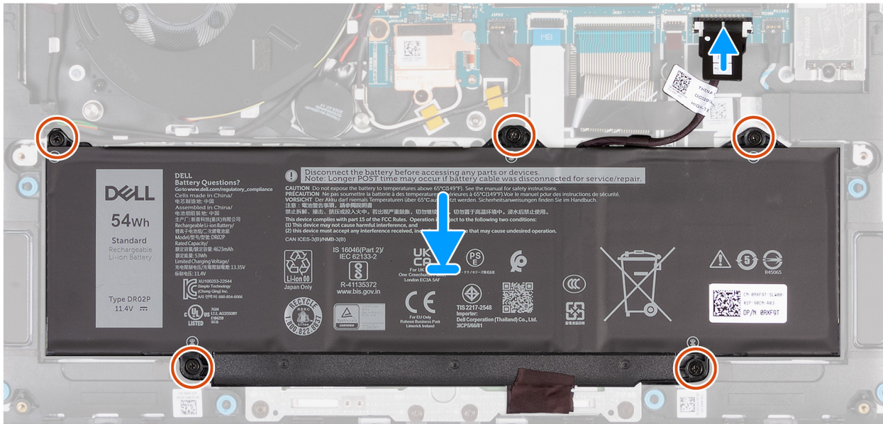
Afbeelding 28. De batterij plaatsen
