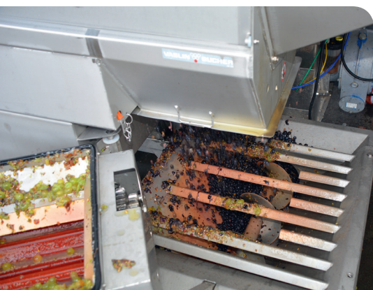
La pompa volumetrica è situata sotto la pigiatrice ed è protetta. L'accesso alla coclea è limitato.
