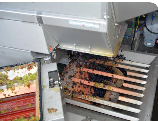
*Die Maischepumpe befindet sich unterhalb der Abbeermaschine und ist so bedeckt. Die Endlosschnecke ist nur eingeschränkt zugänglich.*
