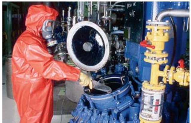
Figura 35: esempio di tuta di protezione integrale
