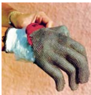
Figura 26: guanto di maglia metallica con inserto termico e igienico
