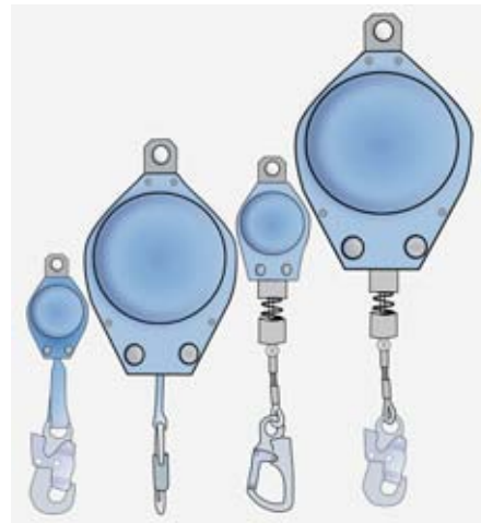
Figura 41: dispositivi anticaduta di tipo retrattile
