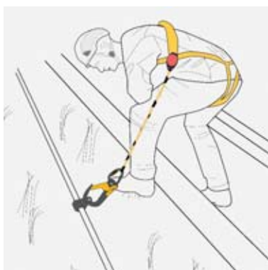
Figura 50: linea di ancoraggio orizzontale permanente
