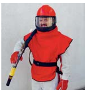
Figura 7: casco per sabbiatura con apporto di aria
