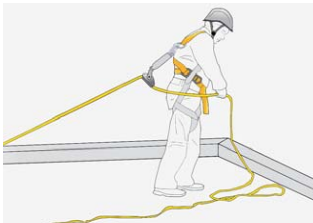
Figura 38: dispositivo di trattenuta
