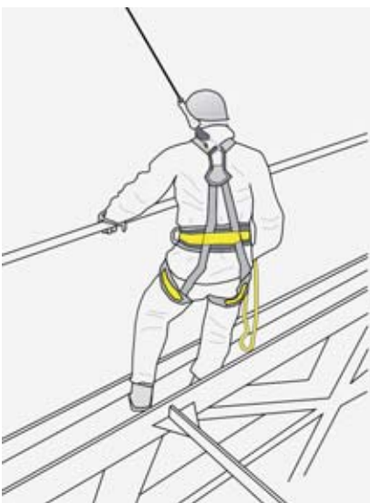
Figura 40: dispositivo di arresto caduta
