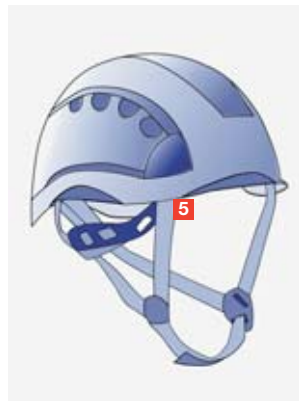
Figura 46: casco con cinturino sottogola
