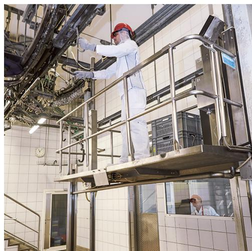
Figura 6: protezione anticaduta adeguata
