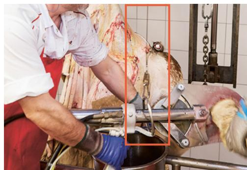
Figura 5: sistema di sospensione per alleggerire il peso della macchina
