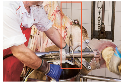
Image 5: système de suspension pour alléger le poids de la machine
