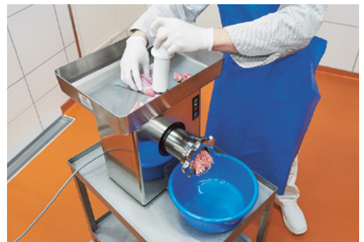
Image 3: introduction de la viande au moyen d'un poussoir
