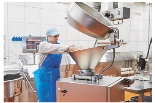
Image 5: la partie supérieure de la trémie est relevée pour prévenir la mise en marche de la machine
