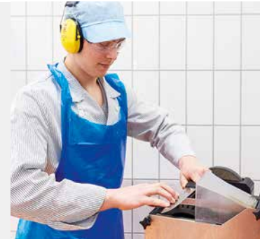
Affûtage mécanique: affûtage à l'aide d'une meuleuse
