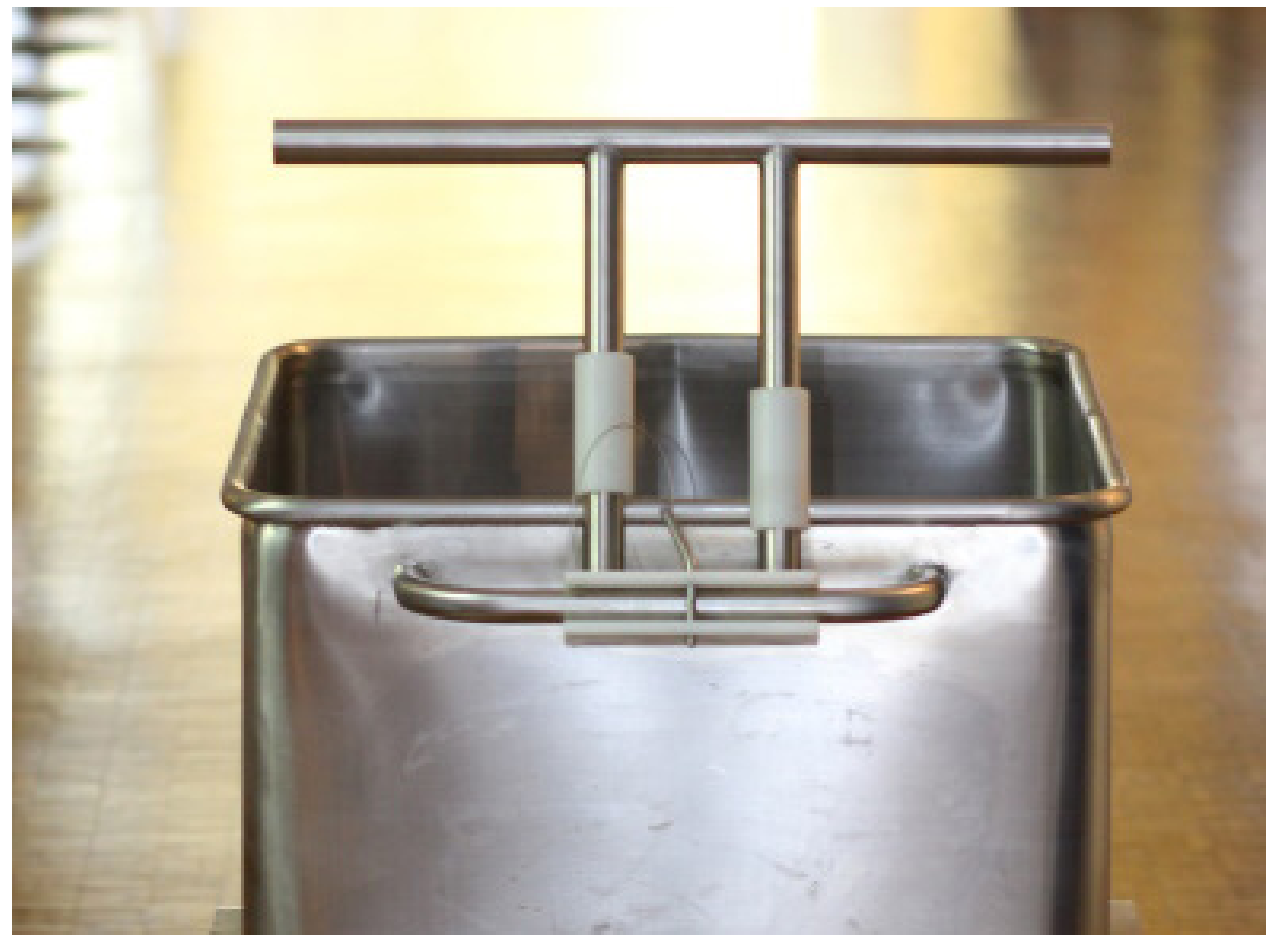
Rallonge de poignée sur le chariot du cutter
