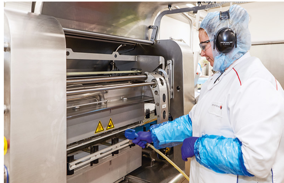
Druckluftpistolen je nach Einsatz: >85 dB(A)
