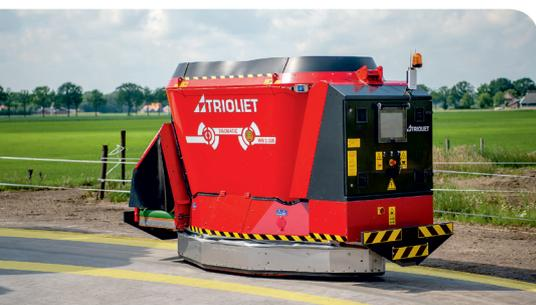
**Mobile Einheiten** sind fahrerlose Maschinen. Sie sind schienengeführt oder fahren auf dem Boden. Die Fahrbereiche auf Verkehrswegen müssen markiert sein. Bild: Trioliet
