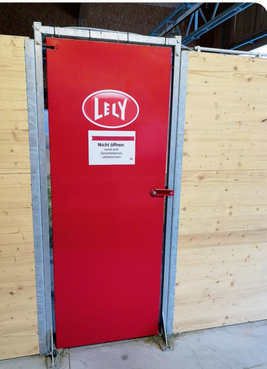
Schutzumzäunungen mit Zugangsüberwachung schützen vor Gefährdungen durch schwebende Lasten und/oder selbstständig arbeitende Teile, die z. B. bei der Beladung der Mobilien Einheit durch Greifer o. ä. bestehen.
