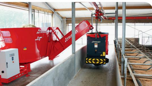
**Automatische Fütterungssysteme** sind automatisierte Anlagen und/oder fahrerlose, mobile Einheiten zum Laden, Mischen, Verteilen und/oder Anchieben von Futter sowie vergleichbaren Anwendungen. Bild: Trioliet
