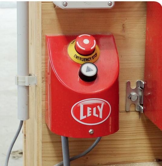
Not-Halt-Befehlseinrichtungen sind in ausreichender Anzahl gut erreichbar und erkennbar vorhanden.
