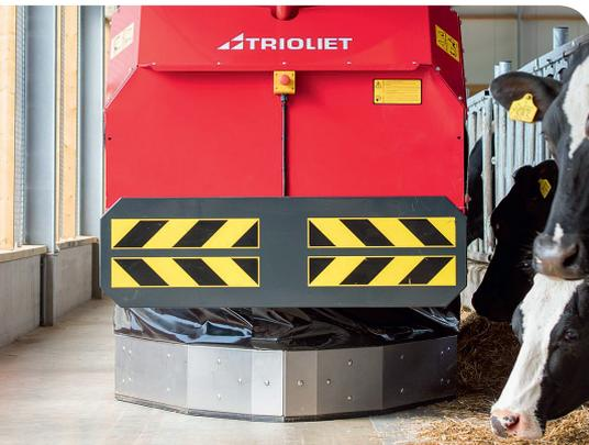
Druckempfindliche Schutzeinrichtungen müssen die ganze Breite der Mobilien Einheit abdecken. Bild: Trioliet
