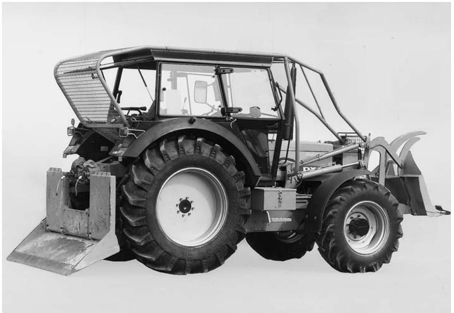
Bild 6 Rückefahrzeug mit Sicherheitskabine, Heckschutzgitter, Rückeschild, Seilwinde und Raum für Zubehör.
