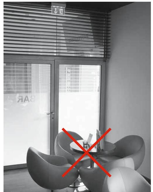
Bild 6: Fluchttüren müssen jederzeit begehbar sein und dürfen nicht versperrt werden.
