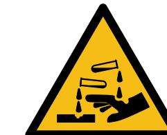
Il segnale di avvertimento «Attenzione: sostanze corrosive» deve essere apposto all'accesso alla zona di pericolo in cui vengono utilizzate soluzioni di clorito di sodio o acido cloridrico.
