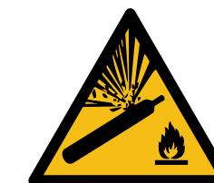
Per impianti di clorurazione che utilizzano gas di cloro, il segnale di avvertimento è «Attenzione: bombole a gas», da apporre all'accesso alla zona pericolosa in cui sono utilizzati contenitori di gas cloro.
