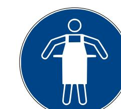
Il segnale di obbligo «Indossare un grembiule di protezione» deve essere apposto nelle aree in cui vengono manipolate direttamente soluzioni di clorito di sodio o acido cloridrico e occorre una protezione del corpo (grembiule protettivo), p. es. durante operazioni di travaso.
