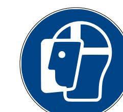
Il segnale di obbligo «Protezione obbligatoria del viso» deve essere apposto nelle aree in cui vengono manipolate direttamente soluzioni di clorito di sodio o acido cloridrico, p. es. durante operazioni di travaso.
