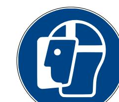
Il segnale di obbligo «Protezione obbligatoria del viso» deve essere apposto nelle aree in cui vengono manipolate direttamente soluzioni di ipoclorito di sodio, p. es. durante operazioni di travaso.
