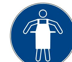
Il segnale di obbligo «Indossare un grembiule di protezione» deve essere apposto nelle aree in cui vengono manipolate direttamente soluzioni di ipoclorito di sodio ed è necessaria una protezione del corpo (grembiule protettivo), p. es. durante operazioni di travaso.
