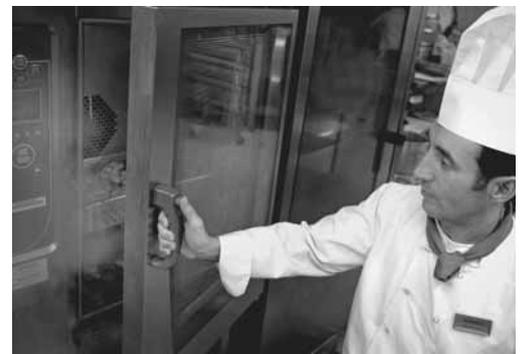
Figure 7: lorsqu'on est placé correctement lors de l'ouverture des portes, ces dernières protègent aussi contre les brûlures.
