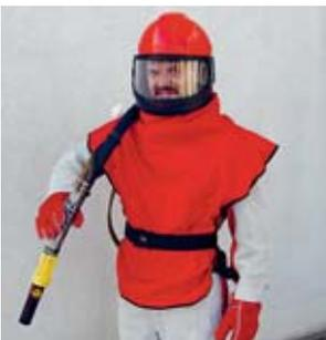
**Bild 7:** Sandstrahlhelm mit Frischluftzufuhr
