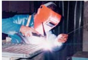
**Bild 10:** Schutzschild nach EN 175
