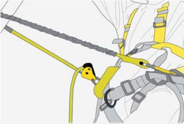
**Bild 39:** Positionierungssystem
