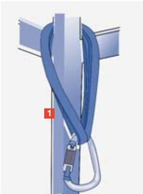
**Bild 45:** Anschlagschlinge
