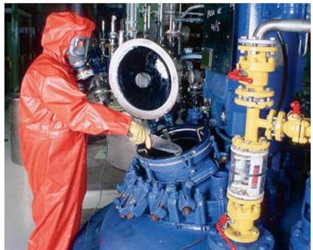
Bild 35: Beispiel Ganzkörper-Schutzanzug
