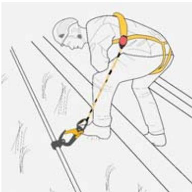
**Bild 50:** Fest installiertes horizontales Sicherungssystem
