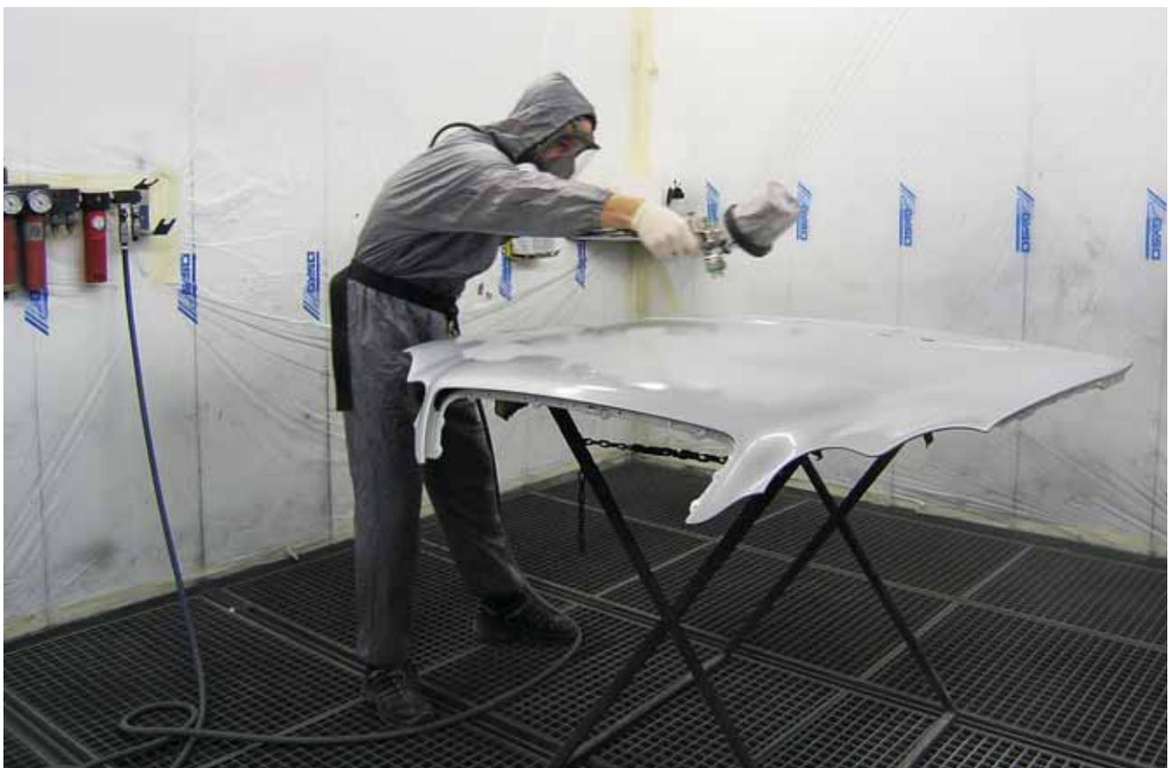
**Bild 6:** Lackierer in Spritzkabine. Die Absaugung ist unten, frische Luft wird von oben zugeführt.
