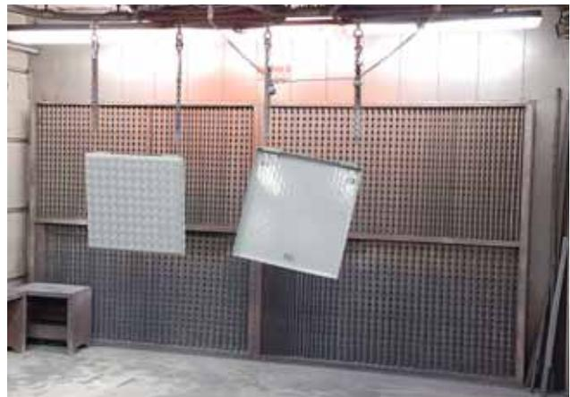
**Bild 5:** Spritzstand mit Absaugwand. Frische Luft wird auf der gegenüberliegenden Raumseite zugeführt. Die Aufhängung verfügt über eine Dreheinrichtung, damit die Teile immer von vorne gespritzt werden können.
