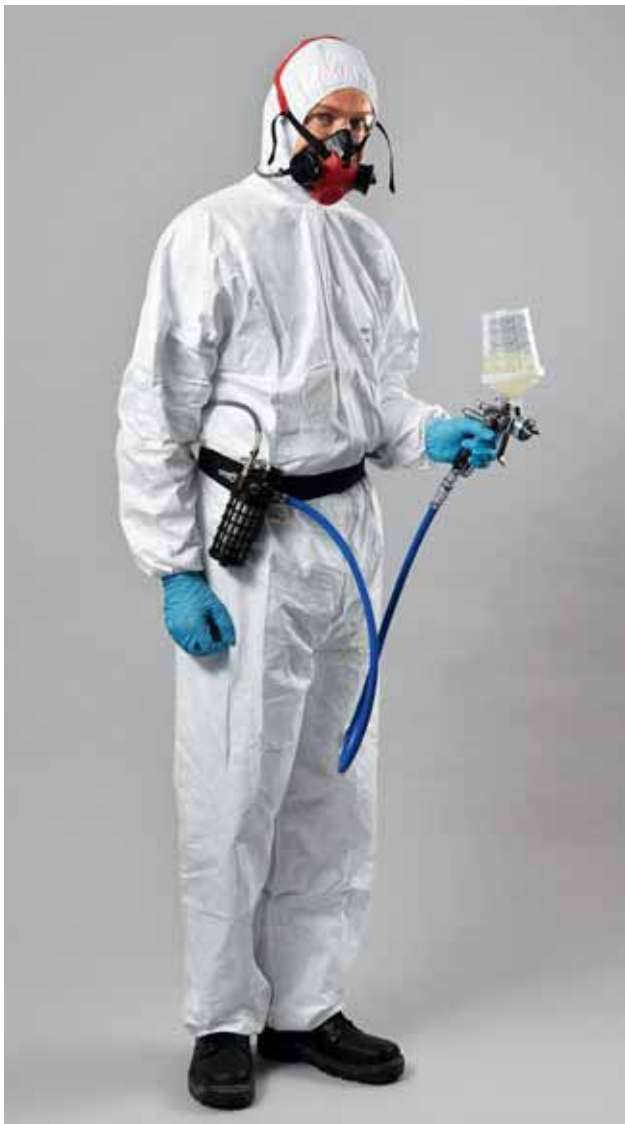
Fig. 9: DPI completi: respiratore ad aria compressa conforme alla norma SN EN 14594 di classe 3 con semimaschera, occhiali di protezione, tuta di protezione dalle sostanze chimiche (tipo 5) e guanti. Il tubo dell'aria compressa viene agganciato alla cintura e fornisce aria alla semimaschera e alla pistola di spruzzatura.
