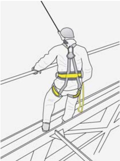
Fig. 40: système d'arrêt de chutes.
