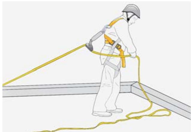
Fig. 38: système de retenue.
