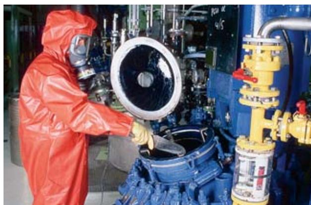
Fig. 35: exemple de combinaison de protection intégrale.
