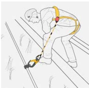
**Fig. 50:** système d'assurage horizontal installé à demeure.
