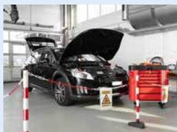
Signaliser le véhicule et interdire l'accès au véhicule.
