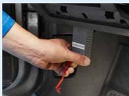
Couper le contact et raccorder le système de diagnostic.
