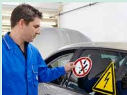
Signaliser le véhicule, apposer des panneaux d'avertissement et si possible interdire l'accès.
