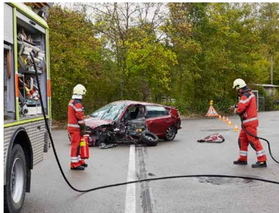
Les véhicules accidentés équipés de systèmes haute tension peuvent présenter différents dangers, par ex. des arcs électriques, des risques d'incendie dus à des fuites de liquides inflammables ou des empoisonnements dus à l'inhalation de substances toxiques.
