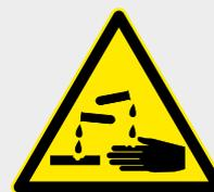
Mise en garde contre les substances corrosives
