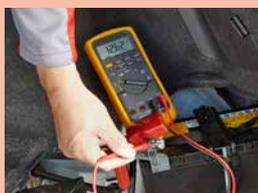
Vérifier l'appareil de mesure sur une batterie 12V (point 1 de la règle des trois points).
