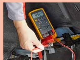
Vérifier à nouveau l'appareil de mesure sur une batterie 12 V (point 3 de la règle des trois points).
