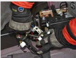
Débrancher la batterie 12 V.
