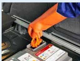
Retirer le connecteur de service de la source d'énergie. Porter des gants isolants, des vêtements de protection à manches longues et un casque de protection contre les arcs électriques.
