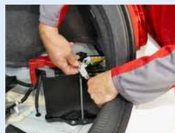
Débrancher le câble négatif (-) de la batterie 12 V.
