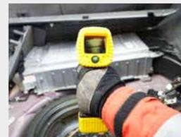
Contrôler l'état mécanique de la batterie haute tension et relever le dégagement de chaleur à l'aide d'une caméra thermique.
