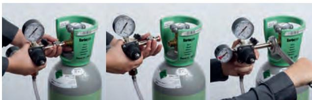
Das Reduzierventil wieder von Hand oder mit einem geeigneten Werkzeug an der Druckgasflasche festschrauben. Dabei darauf achten, dass die Dichtung vorhanden und unbeschädigt ist. Bei Gebrauch eines Werkzeuges nicht zu fest anziehen, da sonst die Dichtung überbeansprucht wird.
