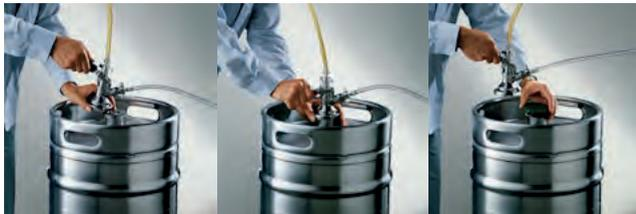
Den Zapfkopf bis zum Anschlag über den Fitting schieben.
