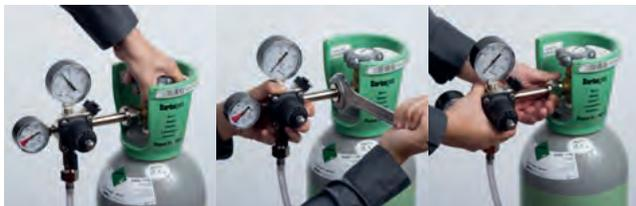
Als Erstes das Ventil der leeren Druckgasflasche schliessen. Den Restdruck durch das Entlüftungs- oder Sicherheitsventil herauslassen, bis kein Gas mehr ausströmt bzw. das Zischen aufhört. Dann das Reduzierventil von Hand oder mit einem passenden Werkzeug abschrauben.
