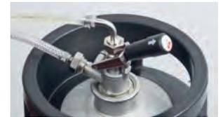
Zapfkopf für Korbfitting in Betrieb (oben), ausser Betrieb (unten)
