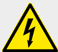
Warnung vor gefährlicher Spannung: Kennzeichnung von Hochvoltssystemen.
