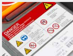
Beispiel eines Warnklebers auf einem Hochvolt-Energieträger
