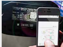
Einzelne Fahrzeuge sind mit direkten QR-Codes gekennzeichnet, die zu den Rettungskarten führen.
