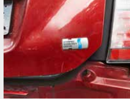
Orange Stecker oder Kabel, erkennbare Fahrzeugbeschriftungen sowie Ladestecker weisen auf ein Elektro- oder Hybridfahrzeug hin.
