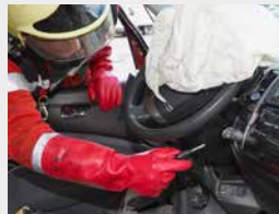
Motorstatus prüfen, System ausschalten, Zündschlüssel aus Fahrgastraum entfernen.
