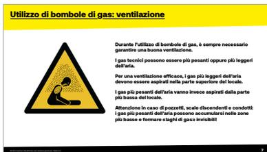
Per i gas più pesanti dell'aria, invece, l'aspirazione deve essere posizionata nella parte inferiore del locale: max. 10 cm dal pavimento. Prestare particolare attenzione a che in prossimità dei luoghi di utilizzo non vi siano aperture nel pavimento, pozzetti o scale per piani inferiori: qui i gas più pesanti dell'aria potrebbero scendere e accumularsi in condotti, locali sotterranei o pozzetti, dove potrebbero formare pericolosi «laghi di gas».
