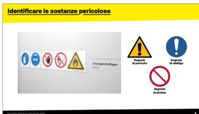
I locali di stoccaggio di sostanze pericolose devono essere contrassegnati – non con pittogrammi GHS ma con segnali di sicurezza conformi alla norma ISO 7010:
