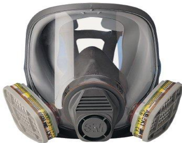
Masque incluant la protection des voies respiratoires et des yeux. Cartouche au charbon actif (bande jaune) efficace contre le SO 2 .
