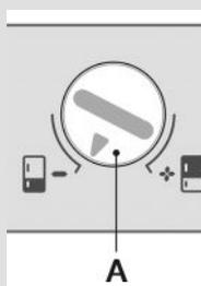
Con la manopola girevole **A**, potete scegliere una parte dell'apparecchio della quale volete vedere sul indicatore la temperatura e con il tasto **E** potete impostare la temperatura desiderata. Per la scelta della parte dell'apparecchio bisogna fare attenzione che la freccia sulla manopola ruotante sia sull'area indicata.
