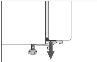
An den Ecken der Gerätetür sind Distanzhalter angebracht, die Sie entfernen und durch die mitgelieferten Stöpsel (nur bei einigen Modellen) ersetzen.
