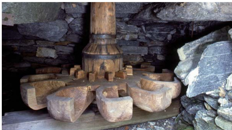
Ruota orizzontale del mulino Maddalena a Gordevio. (Fototeca CDE, DIA-1985/0207)
