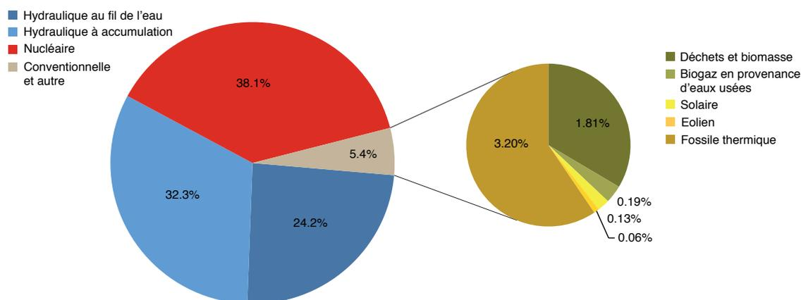
Figure 2: Production d'électricité en Suisse en 2010 (OFEN 2011).
